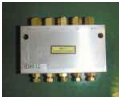
オイルエア分配器（ミキシングバルブ） （dmN値200万を支える）
